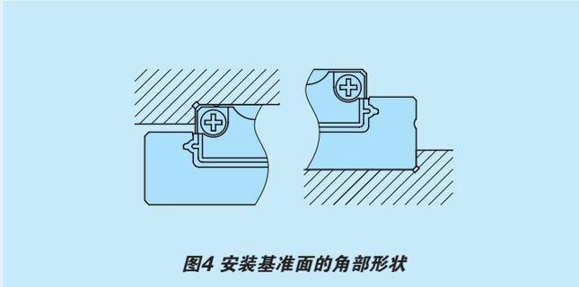
图4 安装基准面的角部形状
